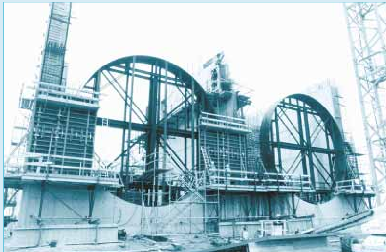
De in grote delen gedemonteerde TBM's
